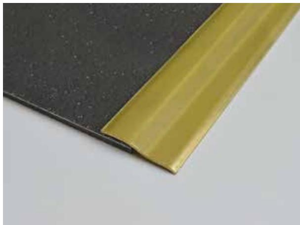
Terminales y topes específicos para superficies de PVC y linóleo u otros materiales muy finos, de 2 ÷ 3 mm de espesor, como prensados o punzonados. Aseguran un acabado con poco incremento de espesor, cubriendo eventuales imperfecciones en el corte del pavimento.
